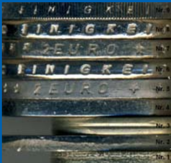
Abb. 4: Beispiele von Rändern von Vorprodukten für zweiteilige Münzen und einer Münze. Erläuterungen zu den Nummern 1 bis 9 siehe Abb.3.
