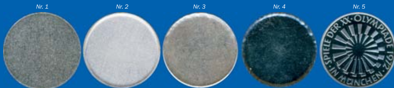
Abb. 1: Beispiele von Oberflächen „einteiliger“ Vorprodukte und einer Münze
